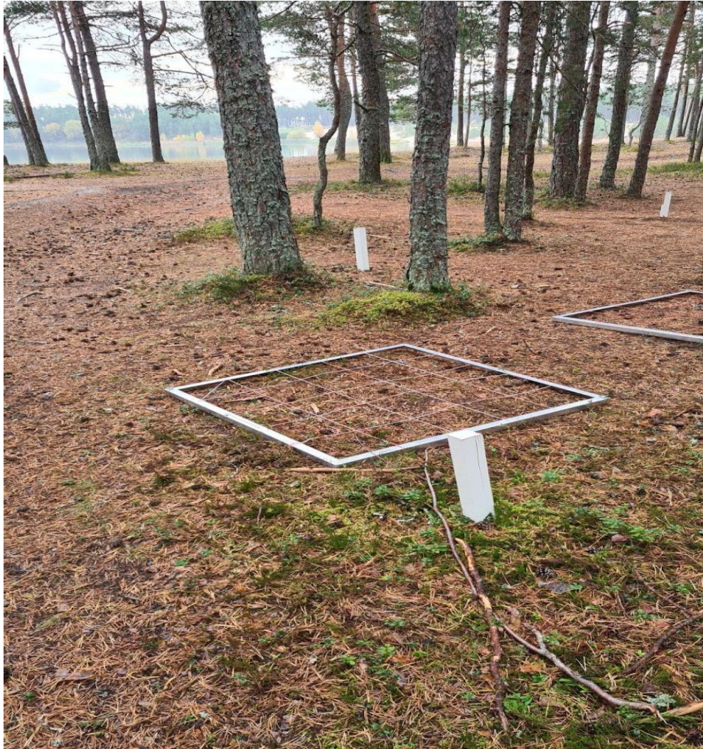
Joonis 2. Pinnase kahjustusastmete määramiseks seiretransektil kasutatav raam.
