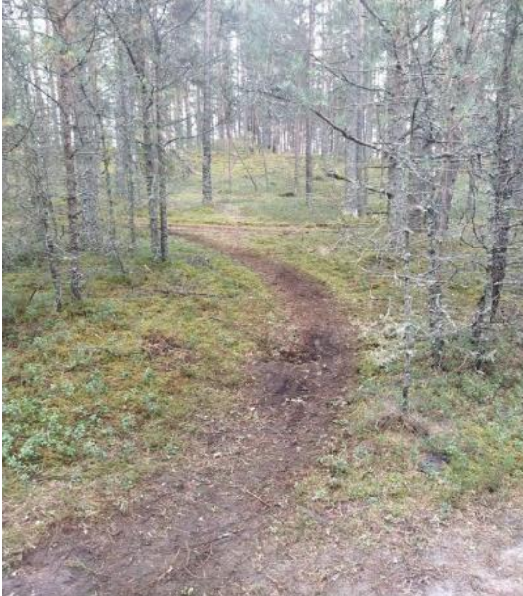
Joonis 5. Maastiku seisukord, peale 500ndat rattapaari läbimist.
