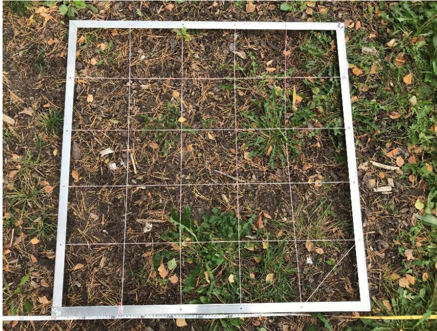
Joonis 15. Pinnase ja taimestiku seisundi ja kahjustuste hindamiseks kasutatav raam (Õun, 2021)
