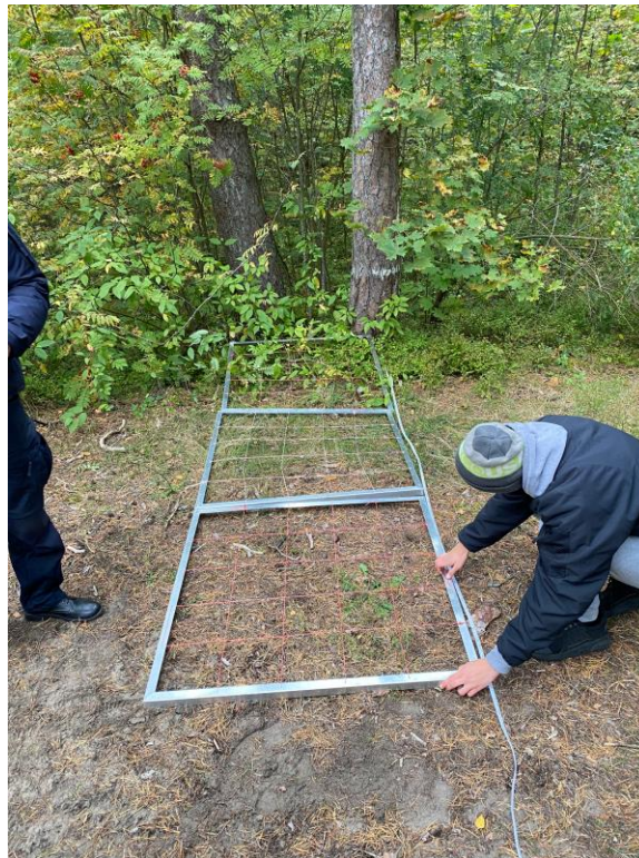
Joonis 2. Kahjustusastmete määramine mõõteraamide abil (Saksing, 2021)
